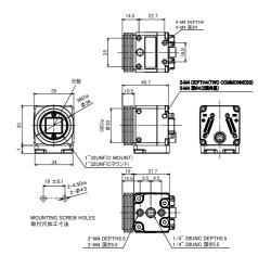
※カメラの底面についている台座は、底面、天面、両側面に取り付けることができます。 台座取り付けねじ(M4×8)を外し、取付け位置を修正してください。 (取付けねじ推奨トルク:1.2N·m)
