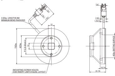
Tightening torque: 1.2N · m
