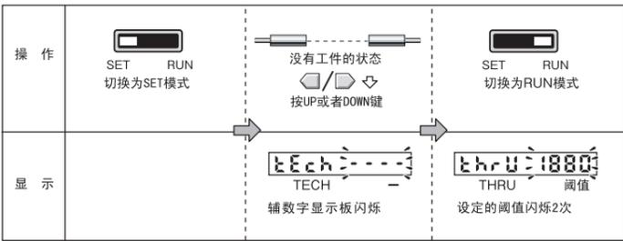
④反射型无工件示教
