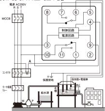
※コモン電極(一番長い電極)を確実にアースしてください。 ※給水と排水とでは配線が一部異なります。 ※電極棒・電極保持器の詳細は各カタログを参照ください。
